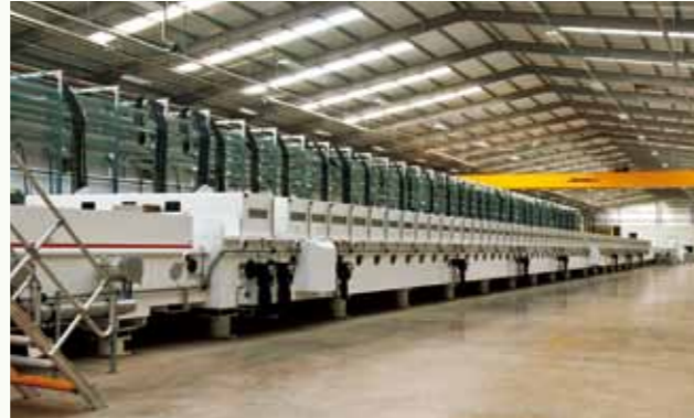
新しいオフラインコーティング装置により、欧州における高付加価値製品の種類を拡充。 2012年11月に英国セントヘレンズで稼動した新しいコーティング装置は、同種の装置の中では世界的にも先進的なものです。当該装置によりガラスに超薄膜特殊コーティングを施すことができ、省エネルギー効果の高い建築用ガラス製品群を生み出します。
